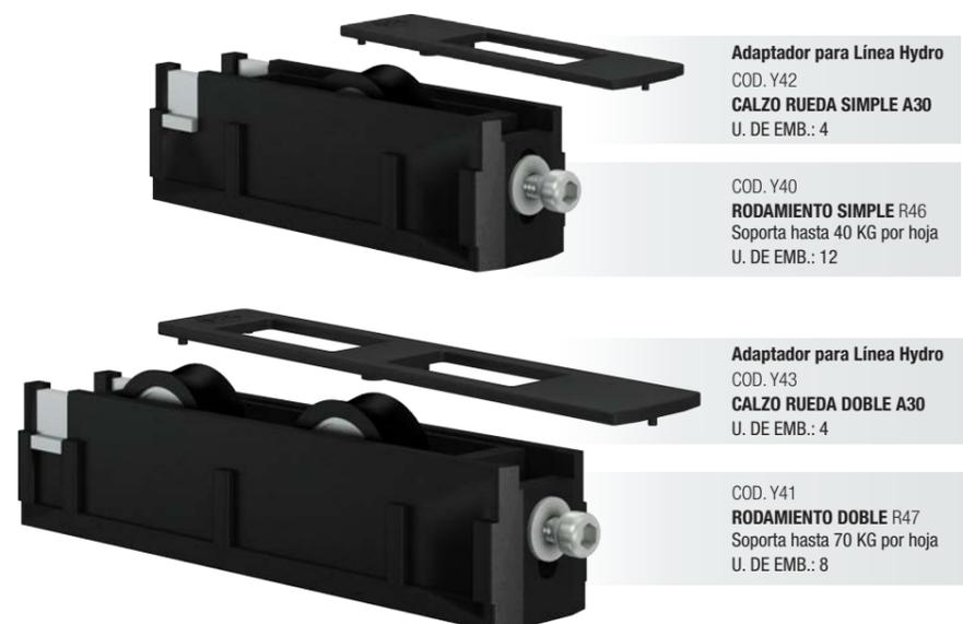
DESCRIPCIÓN: Rulemán blindado con pista interna y externa en acero templado. Banda de rodamiento inyectada en poliamida y torneada. Soporta mayor carga y logra un suave deslizamiento. Carcasa interior en Zamak y exterior en poliamida con carga de fibra de vidrio. Rodamiento simple que soporta hasta 40 kg por hoja y rodamiento doble que soporta hasta 70 kilos por hoja. Compatible con los perfiles de Aluar, Alcemar, Flamia, Hydro y MDT.
